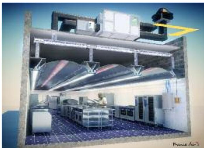
Les équipements en cuisine collective : plafond filtrant toute surface avec éclairage, récupérateur préchauffant l'air de compensation, caisson d'insufflation avec batterie d'appoint pour la mise en chauffe de la cuisine en complément de la récupération d'énergie, système de sécurité incendie, tourelle d'extraction et pilotage de l'installation.
